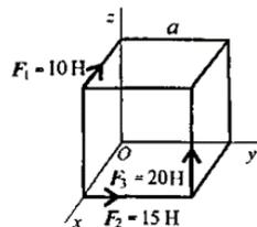
98. Определить величину и направление равнодействующей плоской системы сходящихся сил аналитическим способом.
