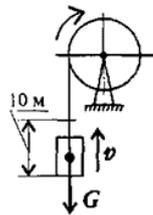
96. На материальную точку действует система сил. Определить числовое значение ускорения, полученного материальной точкой  $m = 7$  кг. Остальные данные представлены на чертеже.
