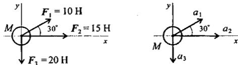
97. На тело в форме куба с ребром,  $a = 10$  см действуют три силы. Определить моменты сил относительно осей координат, совпадающих с ребрами куба.
